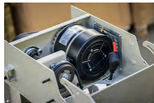
Schwerer Industriemotor 3 kW / 36 Volt.
