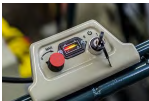
Die Drehzahl läßt sich stufenlos regeln. Die Batterierestlaufzeit wird permanent angezeigt.
