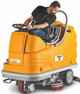
Ihr innovativer Saugfuss ermöglicht das restlose Aufsaugen der Reinigungslösung auch bei Höchstgeschwindigkeit. Der Bürstendruck gewährleistet dabei hundertprozentige Reinigungserfolge. Somit ist die **Diamond 100** nicht nur für die Schwerindustrie qualifiziert, sondern auch für Einsatzbereiche, wo es an Zeit mangelt und dennoch hohe Reinigungsqualität erwartet wird.
