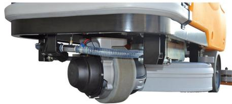
Die Coral 65 M verfügt über einen leistungsstarken Frontantrieb, wodurch die Maschine absolut wendig und leicht zu fahren ist. Durch die kompakte Anbringung des Saugfusses unter der Maschine ist auch die Benützung von Aufzügen möglich.
