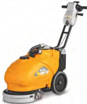
Die Maschine bietet dank der leistungsstarken Batterie eine Betriebsautonomie von über zwei Stunden und kann danach über das Netzkabel (20 m) an das Ladegerät angeschlossen werden, das die Batterien gleichzeitig auflädt.
