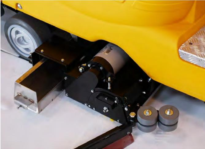
Auch **Sapphire** ist mit dem Brushdry-System ausgestattet. Dies sorgt dafür, dass bei Unterbrechung der Wascharbeit oder bei Arbeitsende die Flüssigkeit sowohl vom Boden als auch aus den Bürsten, dem Saugfuss und dessen Schlauch vollkommen aufgenommen und abgeführt wird, sodass nur völlige Sauberkeit zurück bleibt.
